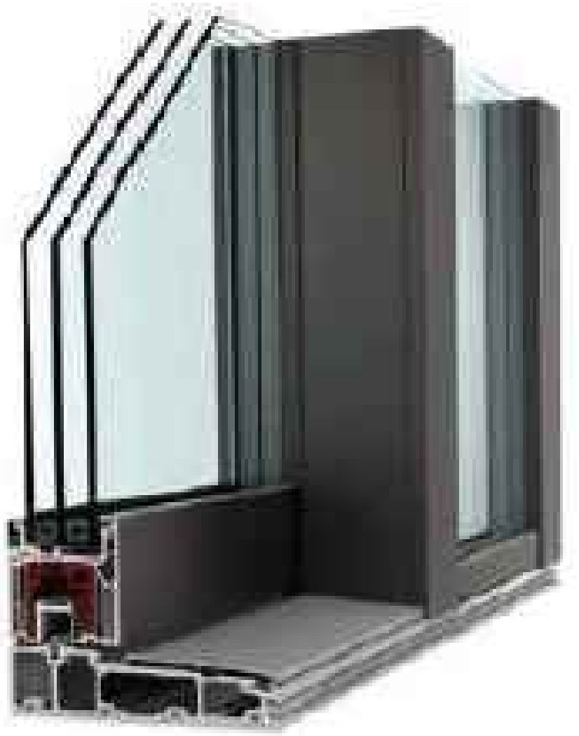
Infissi esterni con telaio metallico a taglio termico con triplo vetro e doppia camera con gas argon - La camera interna all'alloggiamento del vetro ventilata in modo da prevenire eventuali formazioni di condensa in corrispondenza della sigillatura del vetro camera. Accessori di movimento e chiusura di primaria qualità di materiale protetto contro la corrosione con zincatura di 15 micron e successiva passivazione comprendenti cremonesi con maniglia in lega di alluminio e cerniere in numero 2 ,3 o 4 per anta, a seconda delle dimensioni, con perno e rondelle antifrizione. Guarnizioni in EPDM. Qualità certificata secondo D IN7 863 elastometriche resistenti all'invecchiamento alloggiate in una sede continua dei profilati.
